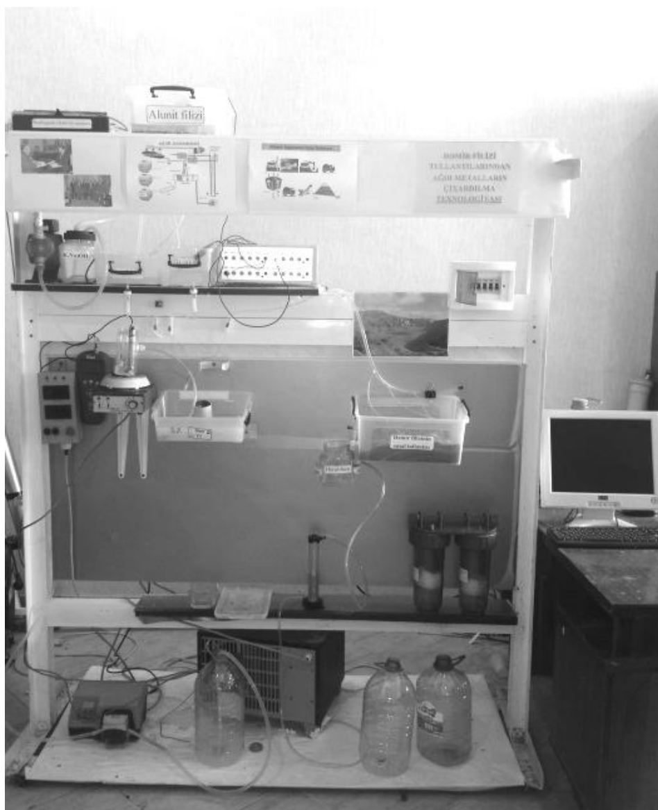
Рис. 3. Разработанный и изготовленный авторами действующий макет технологии переработки алунита
