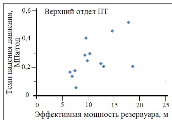
Рис. 13. Зависимость между темпом падения пластового давления за период 1935-1951 гг. и эффективной мощностью резервуаров верхнего отдела ПТ
