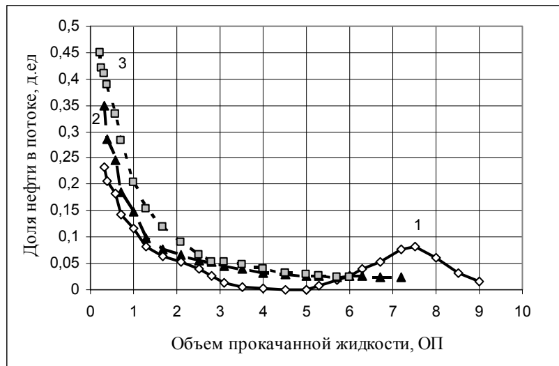
Рис. 4. Доля нефти в потоке жидкости в зависимости от объема прокачанной жидкости при вибровоздействии после окончания водного периода (кр.1), безводного периода (2) и с начала процесса извлечения нефти водой (кр.3) при частоте вибрации 10 Гц и амплитуде 1,67 мм
