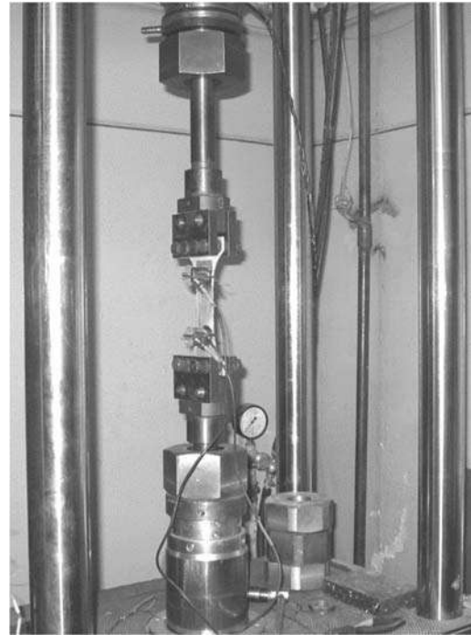
Рис. 2. Вид образца с тензопокрытием и преобразователями сигналов АЭ на стенде MTS
